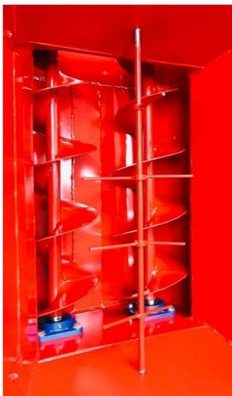
Notre système à double vis effectue un compactage uniforme dans le sac.
